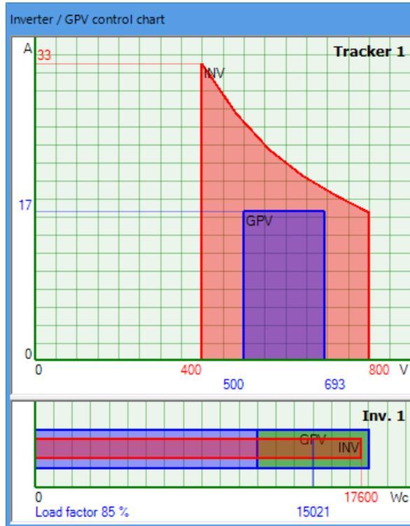
注意：如果项目是通过导入 archelios™ PRO 项目创建的，则此图表的功率值可能会给出无效的结果。这种情况下，主要考虑 archelios™ PRO 计算的验证值，因为它考虑了 archelios™ CALC 不管理的其他参数，例如阴影损失、反射等。在这种情况下，建议通过参考 archelios™ PRO 的计算报告来证明警告消息的合理性。
